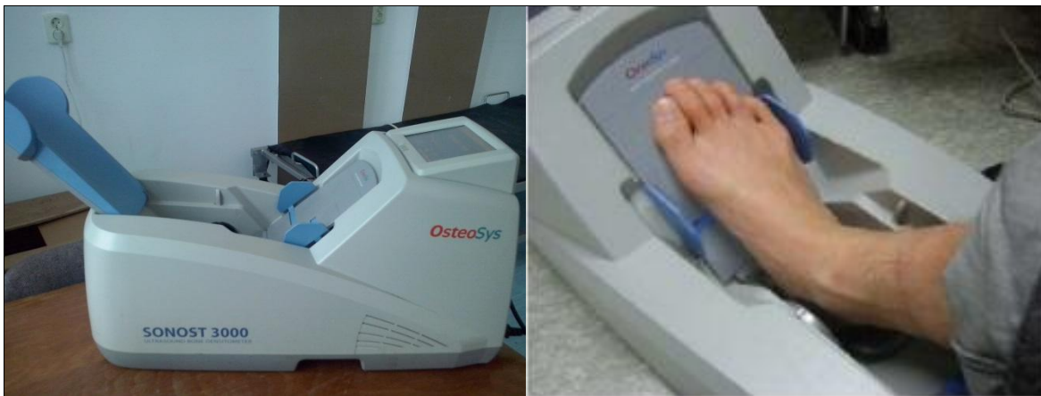
Figura 1. Aparatul OsteoSys 3000 (imagine stânga), măsurarea DMO (imagine dreapta), preluată ( http://www.scribd.com/doc/133342022/SONOST-3000-pdf , fără an)
